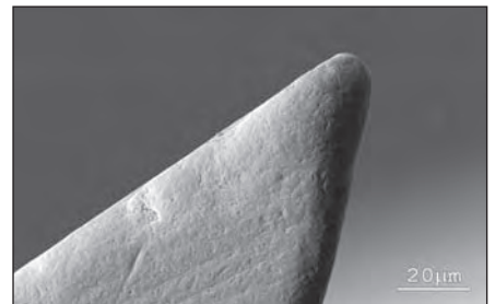
Eliminace odlupování povlaku na ostrých přerušovaných hranách se dosahuje omíláním břitů nástrojů před jejich vlastním povlakováním.
